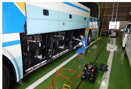
ラゲッジスペースの抗ウイルス施工 (大阪空港交通(株))
